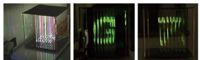
図3：糸を用いたボリュームディスプレイ
