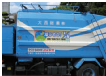
4tパッカー車（一般廃棄物収集用車両）
