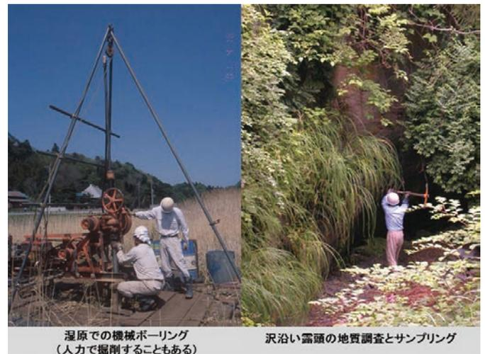
湿原での機械ボーリング (人力で掘削することもある) 沢沿い露頭の地質調査とサンプリング
