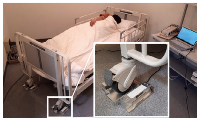
図1：ベッドに配置した高性能ロードセル
