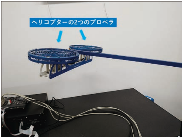
図3：ヘリコプターのホバリング制御（ヘリコプターの2つのプロペラを制御して、ヘリコプターの浮上や空中での静止を最適に制御するシステム）
