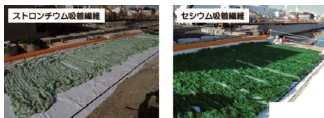
図1：セシウムおよびストロンチウム除去用吸着繊維の汚染海水への試験導入
