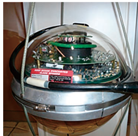
ニュートリノ検出器モジュール単体
