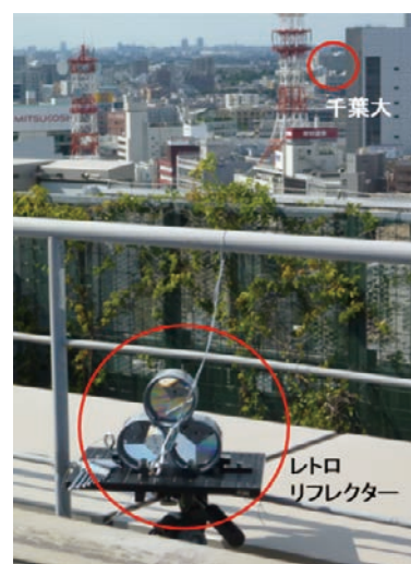
図2 千葉市科学館屋上に設置した反射装置（レトロリフレクター）と、2.5km離れた千葉大学工学系総合研究棟
